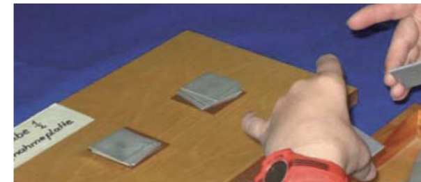
Gruppe 1: Einfachstes Hinlangen, Greifen und Bringen – Aufgabe 1.2: Von zwei Stapeln mit jeweils 20 Metallplatten soll beidhändig jeweils eine Platte in eine Kiste abgelegt werden. 2 Fehler in 48 Sekunden, Einstufung mit 41%
